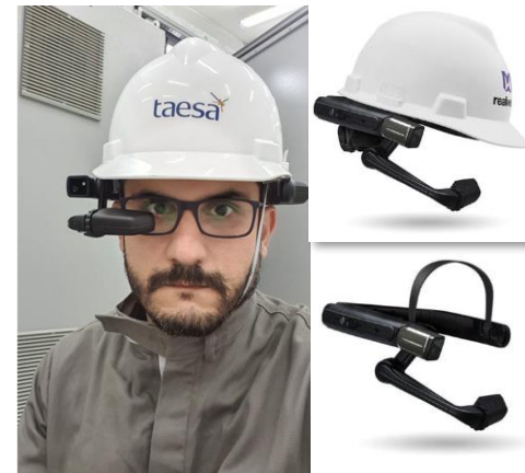
Dispositivos de realidade aumentada para inspeções, testes e ensaios em tempo real
